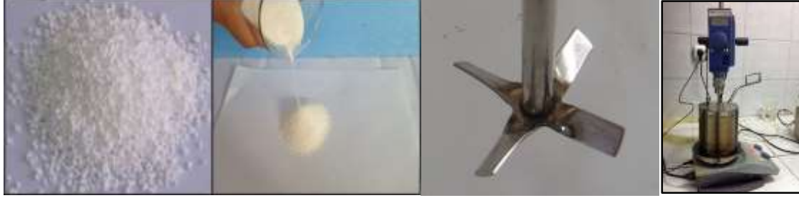
Şekil 1. SBS polimeri, kullanılan başlık ve karıştırma mikseri
