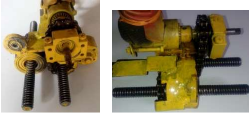
Şekil 4. Trapez vidaların rulmanlarla montajı
