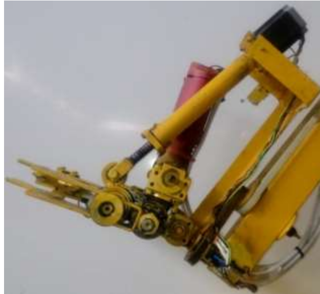
Şekil 8. Robot tutucusunun robot kola montajı
