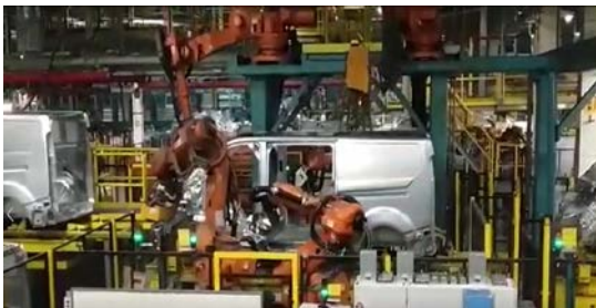
Şekil 2. Çok robotlu nokta kaynak istasyonu – Ford Otosan Gölcük Fabrikası
