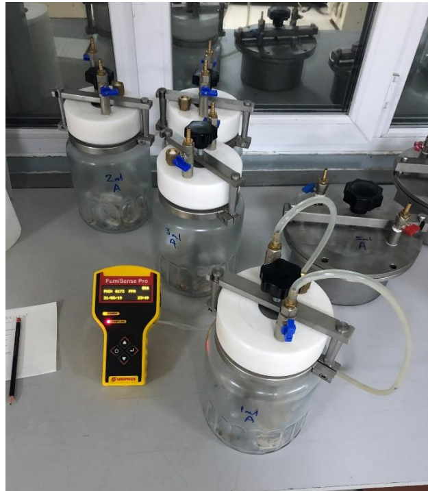
Şekil 1. Çalışmalarda kullanılan 3 L hacimli fümigasyon birimleri ve fosfin gazı ölçüm cihazı
