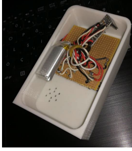
Şekil 16. Elektronik ekipmanların dış kasa içerisine yerleştirilmesi
