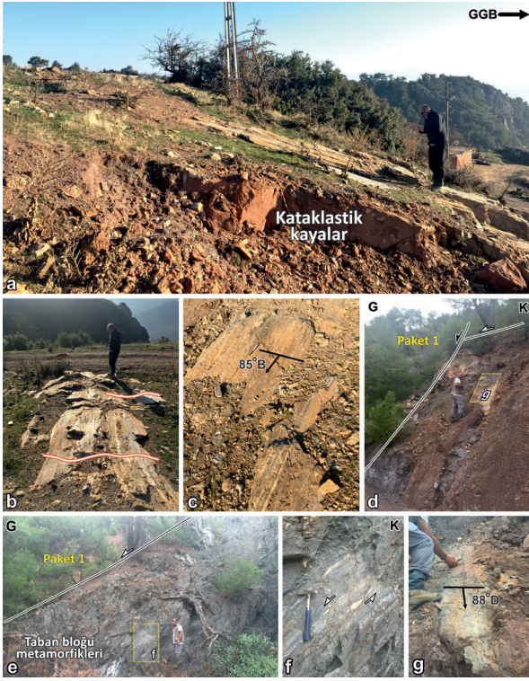
Şekil 11. İnceleme alanında gözlenen yapısal öğelere ait arazi fotoğrafları. (a) Büyük Menderes Sıyırılma Fayı'na ait düşük açılı fay düzlemi altındaki taban bloğunda gözlenen kataklastik kayalar, (b) BMSF'nin fay düzlemi üzerindeki ondülasyonlar (kırmızı gölgeli beyaz kalın çizgiler ondülasyonun geometrisini yansıtır), (c) yüksek yan yatım açısına sahip fay çizikleri, (d) düşük açılı fayı kesen yüksek açılı eğim atımlı normal fay, (e, f) BMSF'nin taban bloğundaki milonitik kayalarda gözlenen asimetrik yapılar, (g) yüksek açılı fay düzlemi üzerindeki fay çizikleri. Jeolog 177cm, çekiç 30 cm, kalem 14 cm'dir.
