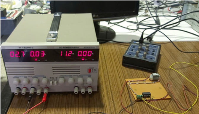
Resim 5. Motor Titreşim Ölçümü Test Düzeneği
