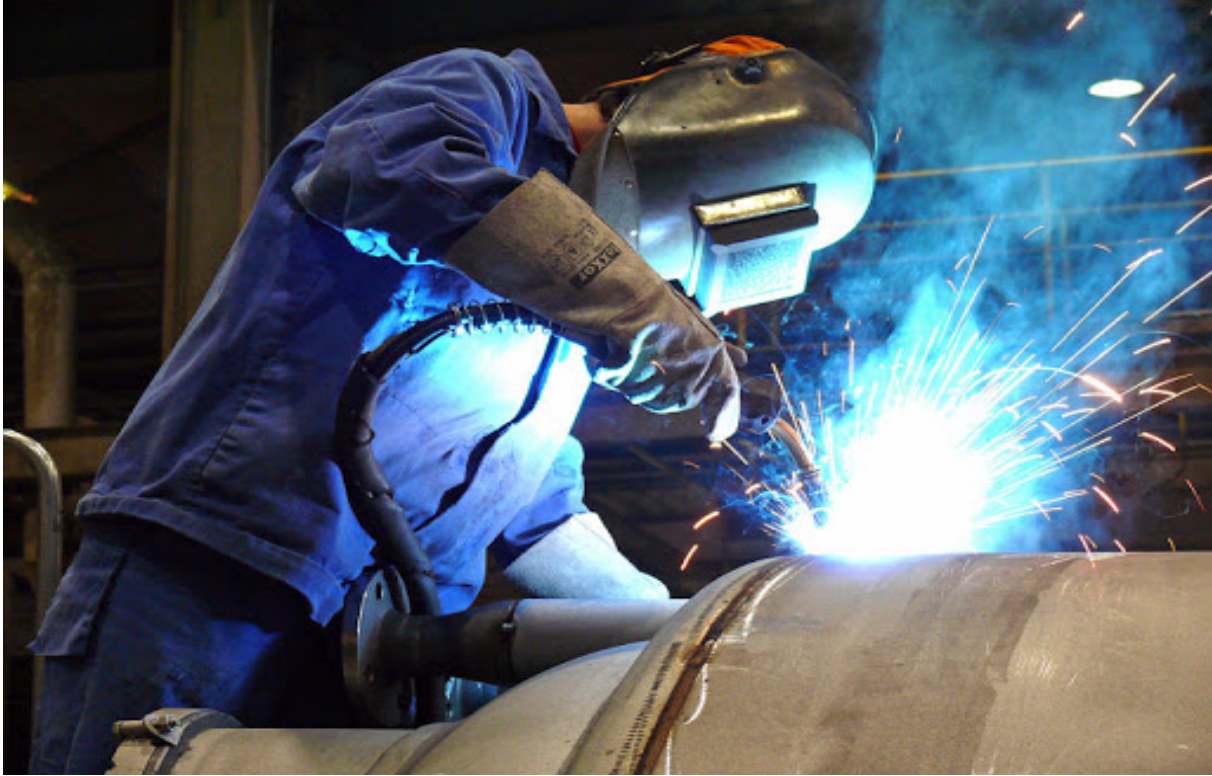
Şekil 6. Basıncılı Tanklarda Sıcak İş Çalışması
