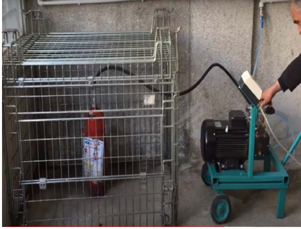
Şekil 5.a. Korumalı Alanda Basınç Testi
