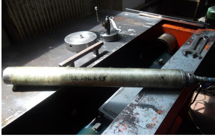
Şekil 8. Ekipmanları bağlanmış kompozit sargılı boru
