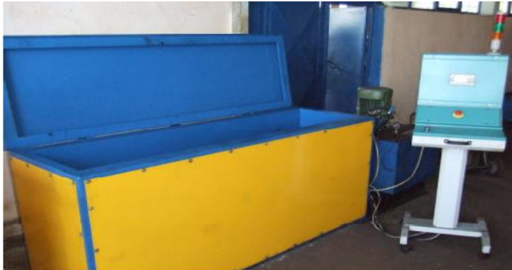
Şekil 7. PLC kontrollü, servo motorlu hidrolik test cihazı
