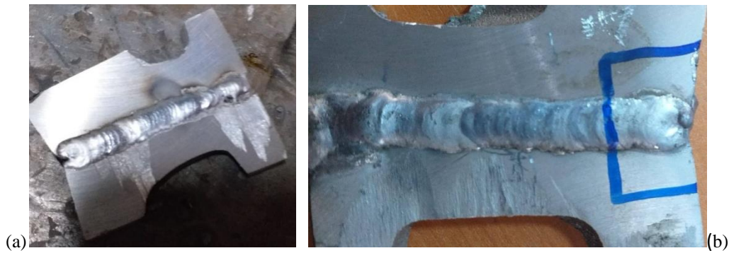
Şekil 6. Birleştirilen numuneler; (a) 1. Paso (b) 2. (son) paso
