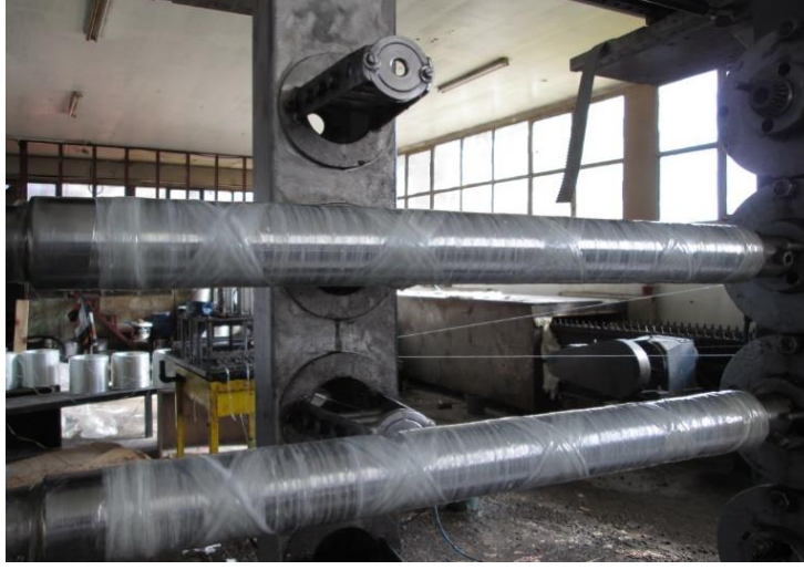
Şekil 5. İstenilen açılarda elyaf sarımının yapılması
