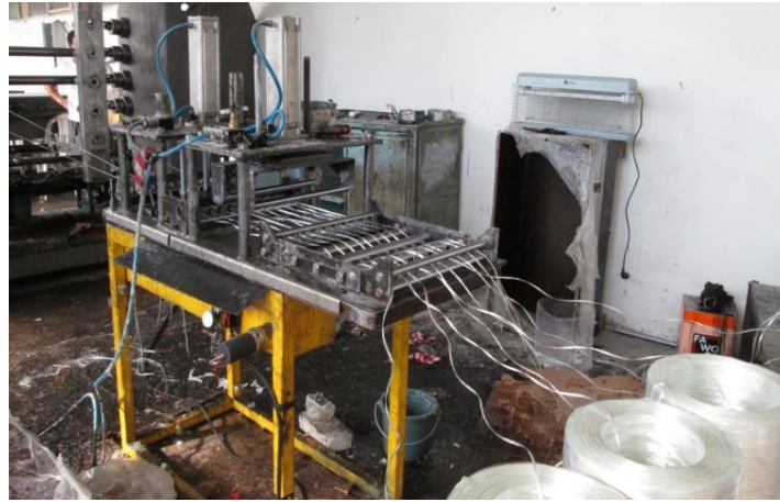
Şekil 4. Kompozit sargılı boru imalatı
