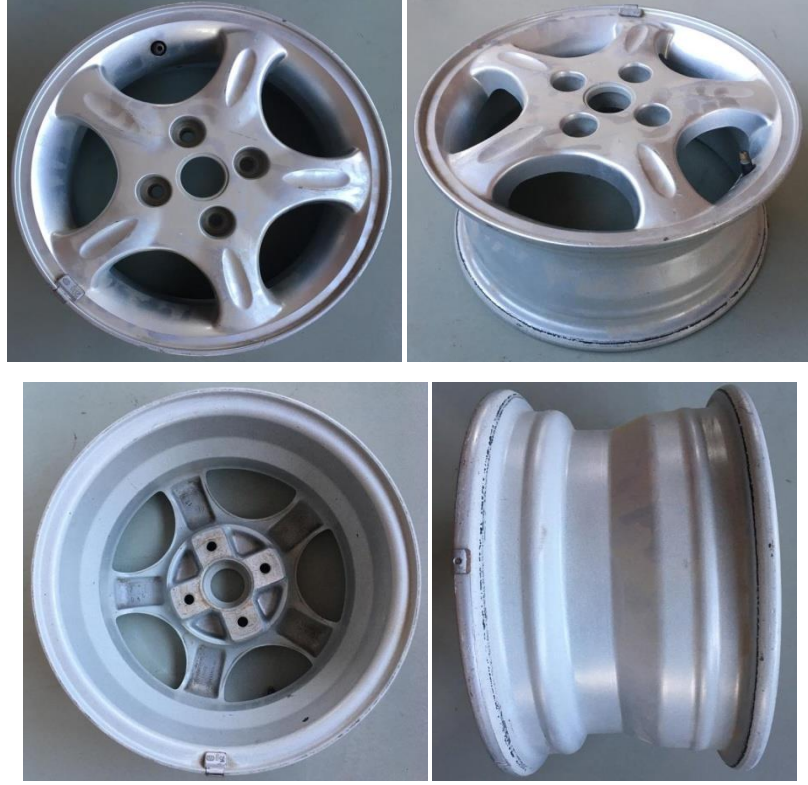
Şekil 1. Orijinal 13 inch yerli üretim otomobil jantı
