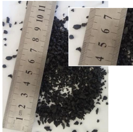
Şekil 1. Ögütülmüş Araç Lastiği Agregası (ÖALA)
