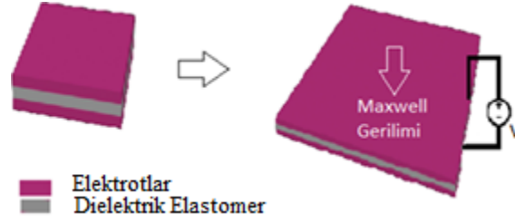
Şekil 1. Dielektrik elastomer aktüatörün çalışma prensibi.
