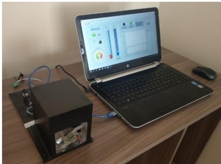
Şekil 2. Sıcaklık kontrol sisteminin genel görünümü.
