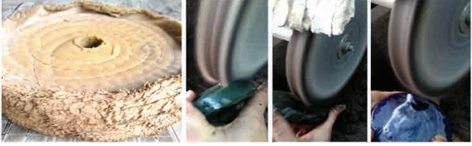
G. 11. Bez kafada camlara açma işleminin uygulanması (Özge Biçer, 2018)
