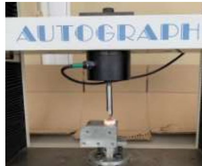
Resim 1. Kırılma deneyi (Autograph AGS-J; Shimadzu, Tokyo, Japan) uygulaması
