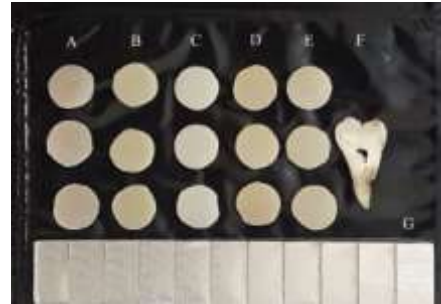
Şekil 1. Materyallerin oklüzal film üzerine yerleştirilmesi [A) Aeliteflo B) Brillant ever glow C) Dynamic flow D) G-aenial Universal Flo E) Novo compo-HF F) Mine-Dentin Kesiti G) Alüminyum Stepwedge]
