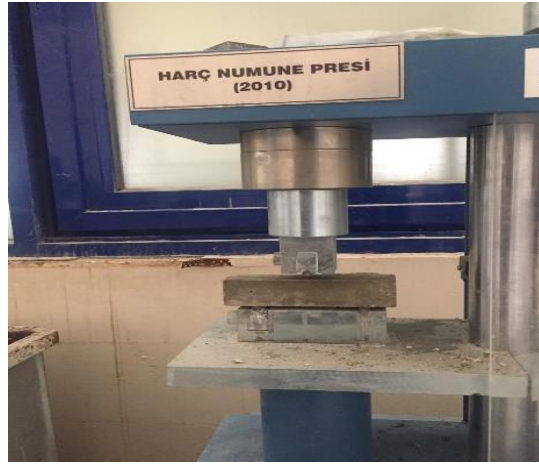
Şekil 2. Numuneye eğilme ve basınç deneylerinin yapılması
