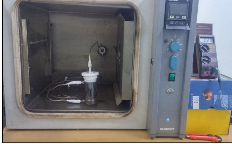
Şekil 4. Tutuşma sıcaklığı deney seti görünümü [17]
