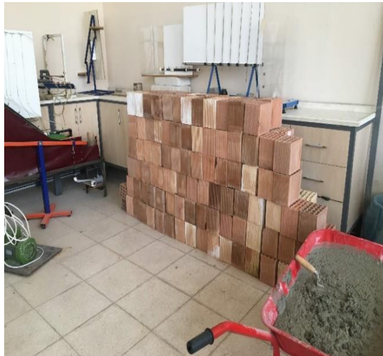
Şekil 1. 19*19*8.5 cm tuğla numuneleri
