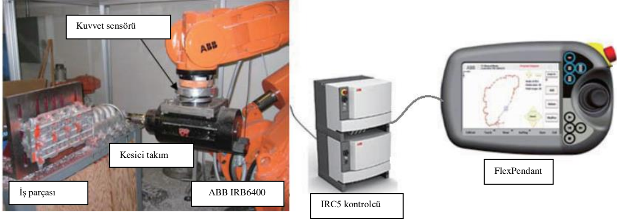
Şekil 12. Kuvvet kontrollü SKR uygulaması [44]
