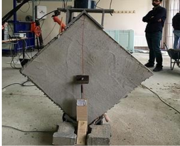
Şekil 5. Potansiyometre'nin (LVDT) düzeneğe yerleştirilmesi
