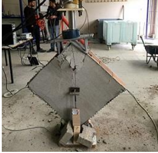
Şekil 8. Çift yüze uygulanmış plastik kompozit donatılı duvarın son durumu
