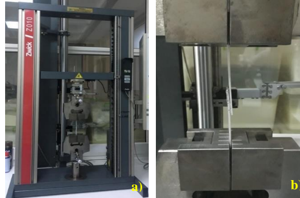
Şekil 7. a) Zwick Z010 model çekme test cihazı, b) Makine çenesine bağlanmış test numunesi
