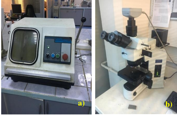
Şekil 9. a) Numune kesme işlemi yapılan Buehler Abrasimet 2 cihazı, b) Mikroyapı görüntüleri alınan Olympus BX61M model mikroskop cihazı
