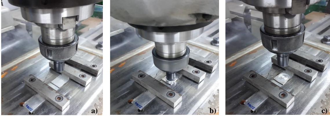
Şekil 5. a) SKNK işlemi öncesi parçaların fikstüre sabitlenmesi, b) SKNK uygulaması, c) SKNK sonrası birleşen numuneler
