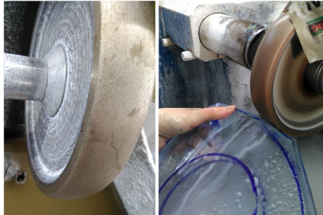
Resim 3. 46 gritlik elmas aşındırıcı ile camın kenarlarının düzeltilmesi
