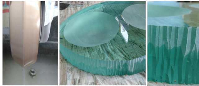
Resim 13. 600 gritlik Kesme elmas aşındırma diskleri ile camın kenarlarının istenilen dekorun verilerek zeyim işleminden geçirilmesi
