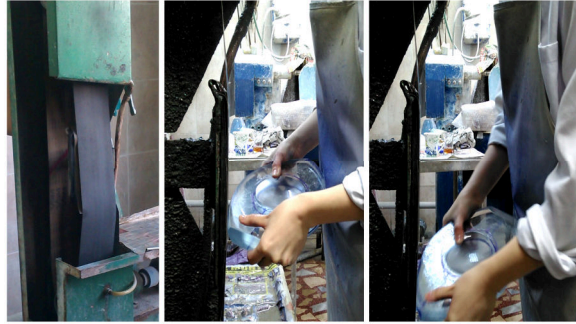
Resim 5. 120 gritlik kum bant zımpara camın kenarlarındaki kum taşının aşındırma izlerinin alınması
