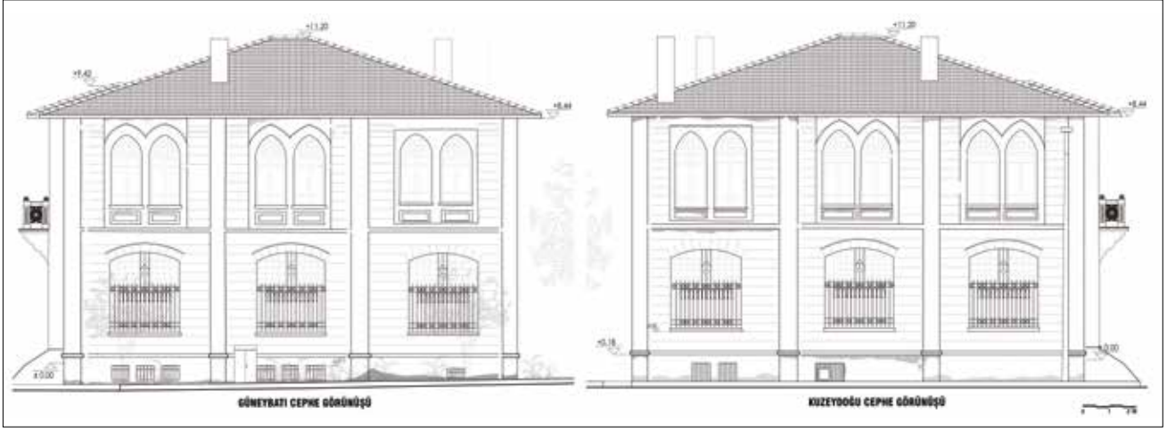
Şekil 8. Güneybatı(sağ yan) ve kuzeydoğu(sol yan) cepheleri rölevelleri. / Survey drawings of southwest (right) and northeast (left) elevations.
