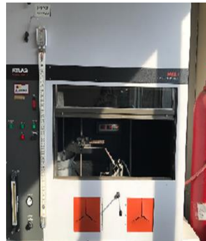
Şekil 2. LOI ve yatay yanma hızı ölçüm cihazı
