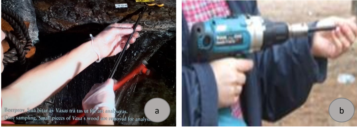
Şekil 2. a:Wasa müzesinde koruma altındaki ahşap gemiden teşhis için odun örneklerinin nasıl alındığına dair gösterim (Foto: Bilgin İÇEL); b: 2015 yılında yapılan örneklemede kullanılan modifiye edilmiş cihaz (Bilgin İÇEL)
