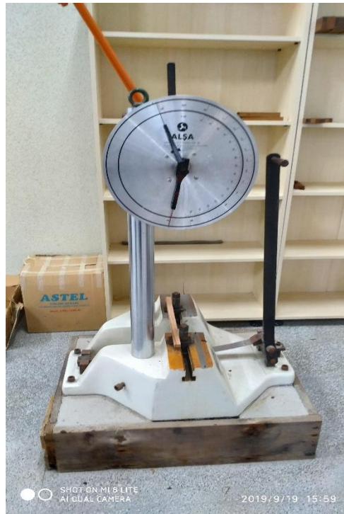
Resim 3. Dinamik eğilme (şok) direnci deneyi.
