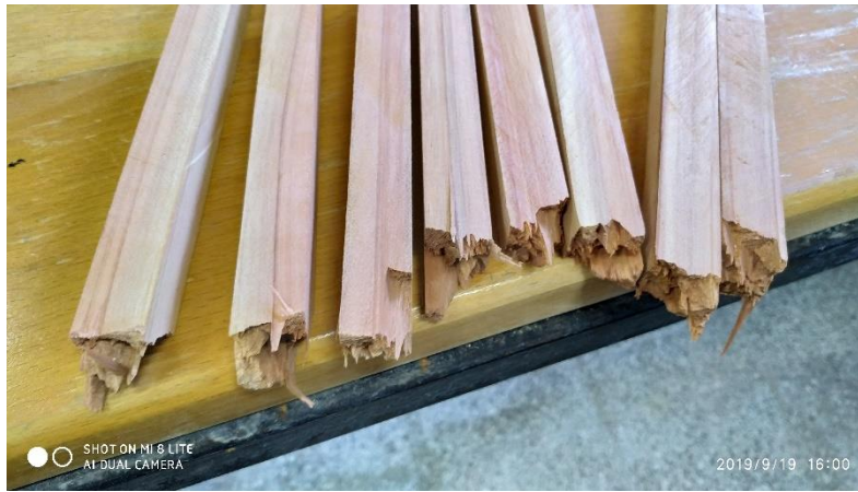
Resim 4. Şok direnci kırılma örnekleri.
