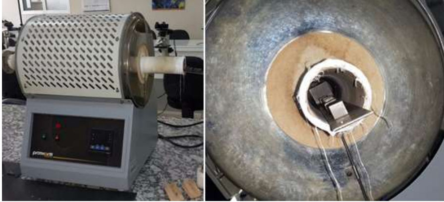
Şekil 3. Pekleşme sonrası yeniden kristalleşme işlemi
