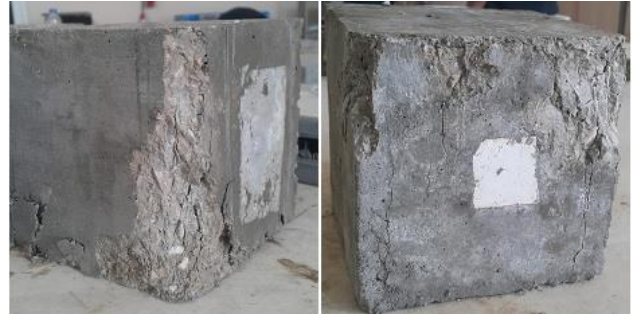
Şekil 12. Şahit1 ve Şahit2 küp numunelerinin basınç dayanımı test edildikten sonraki durumları
