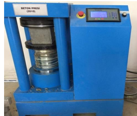
Şekil 5. Küp numunelerin basınç dayanım testi
