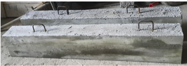
Şekil 7. 7 günlük kür işlemi ardından kalıptan çıkarılan kirişler
