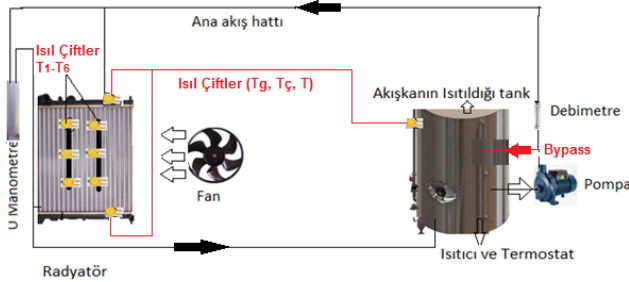
Şekil 1. Deney seti ve akış diyagramı
