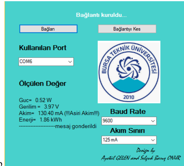
Şekil 6. PC kullanıcı arayüzü (a) Normal durum (b) Aşırı akım durumu
