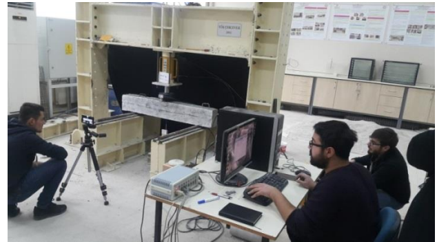
Şekil 9. 3 noktalı yükleme deneyi ve verilerin toplanması
