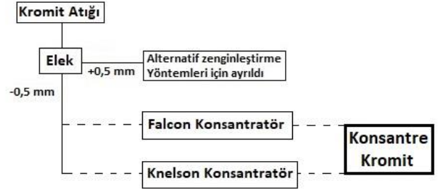
Şekil 1. Deneysel akım şeması.
