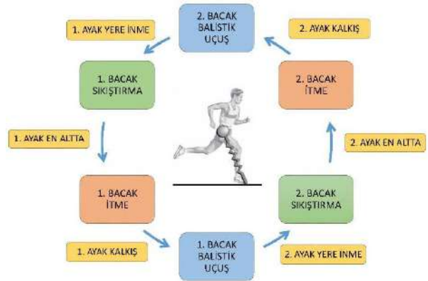
Şekil 28. Koşma modeli ile SLIP modelinin benzeşimini gösteren çizimler. (Drawings illustrating the similarity of SLIP model with the running model.)
