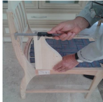
Resim 4. Sandalyede arkalık açıklık “a” ölçümü (Backrest clearance “a” measurement in the chair)
