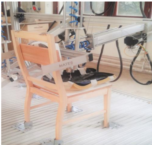
Resim 2. Oturma yeri ve arkalık statik yük testi uygulaması (Seating and back rest static load test application)
