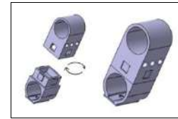
Şekil 7. Yenilikçi modele ait iki parçadan oluşan ara parça (Two-piece spacer of the innovative model)
