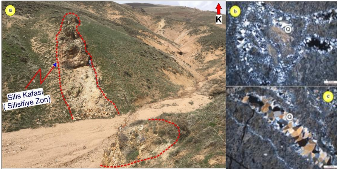
Şekil 10. İnceleme alanında gözlen (a) silisifiye zonun, (b) ve (c) silisleşmenin ince kesit görünümü (Q: Kuvars)
