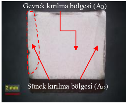
Şekil 9. Çentik darbe testi sonrası oluşan kırılma yüzeyi
