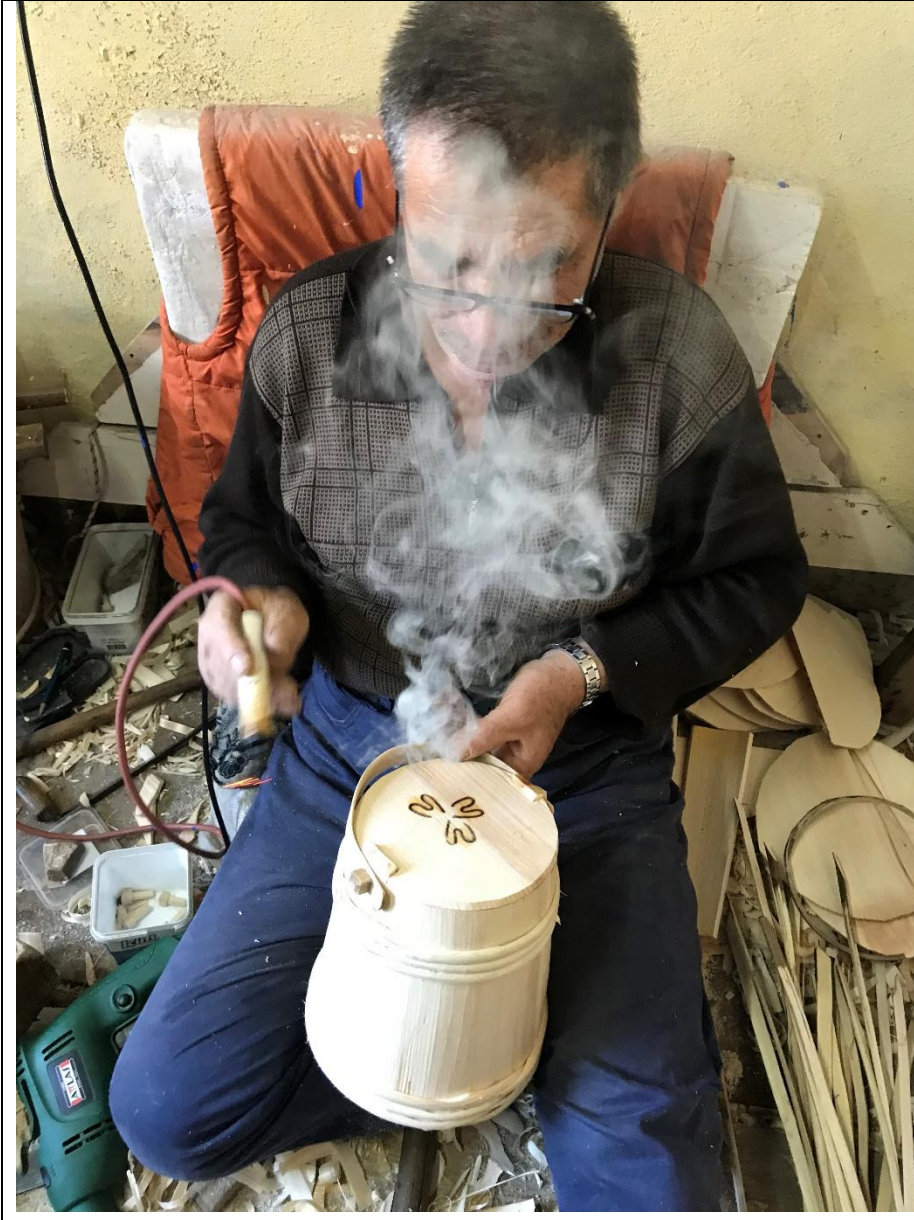
Foto 5. Ahşap ürünlerin üretiminde hava deneni aletle kabın üzerine motif çizilerek işlem tamamlanmaktadır.
