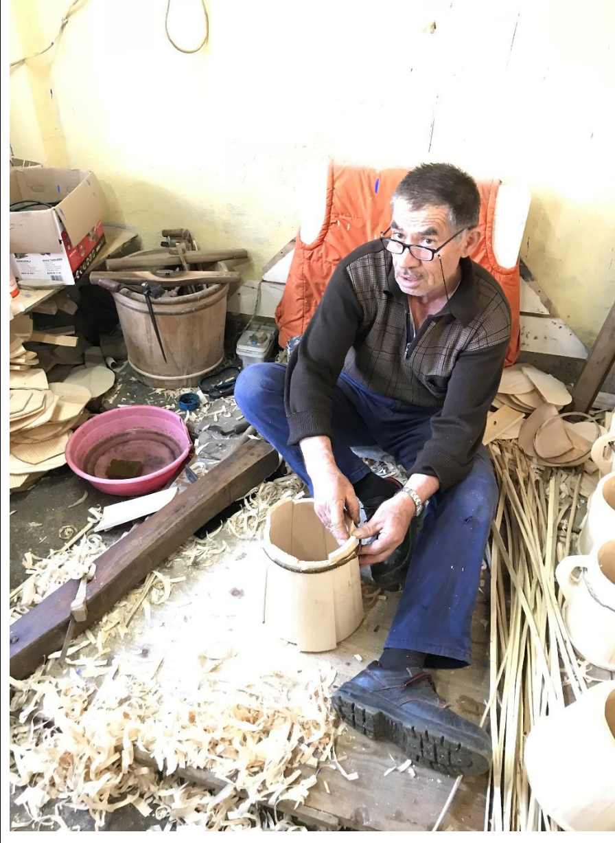
Foto 3. Kuşak bağlama işleminde fındık dalı, kap ölçüsünde ayarlayarak çivisiz olarak tahtaların birbirine bağlanması için kullanılır.
