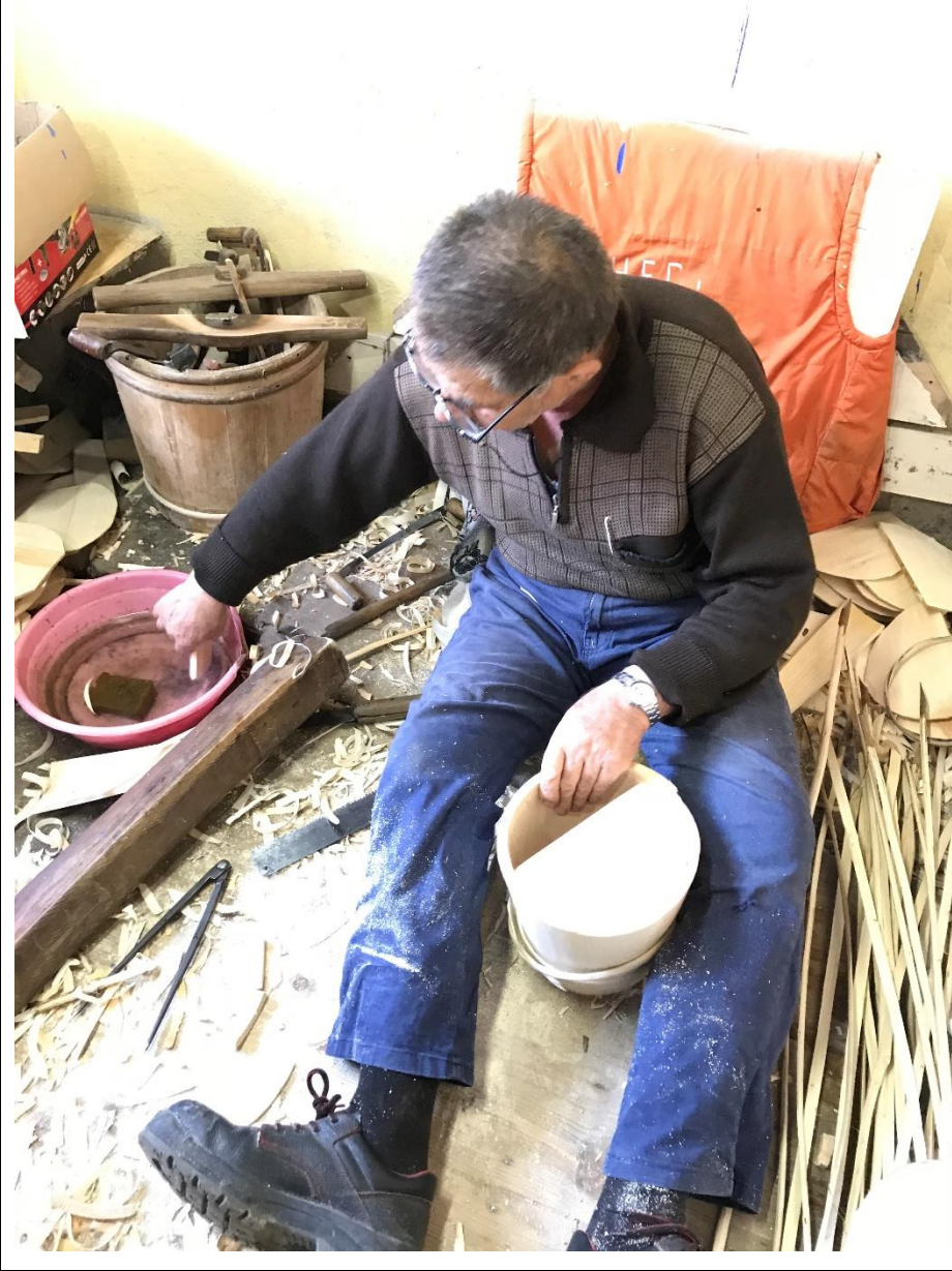
Foto 4. Tabanlık kısmının hazırlanması işlemi, altı pergel çapında olacak şekilde ölçülüp ayarlanarak, ölçüye göre kabın tabanına yerleştirilecek gerçekleştirilmektedir.
