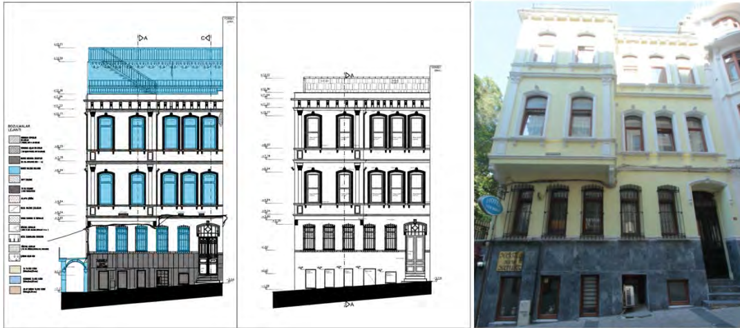
Şekil 17. Yapının cephesine ait bozulmaları gösteren rölöve , restitüsyon karşılaştırması ve cephe fotoğrafı (Çizen: İlke Ciritci)
