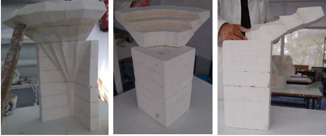
Şekil 30: Divriği Şifahanesi altı kenarlı tonozunun kenar hatlarının montajı (Sevda Atak, 2017).
