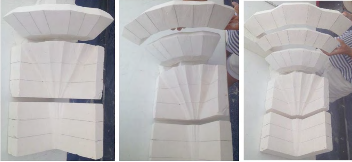
Şekil 29: Divriği Şifahanesi altı kenarlı tonozunun impostası ile eğimli sıralarından oluşan kesme taşlarının montaj aşaması (Sevda Atak, 2017).
