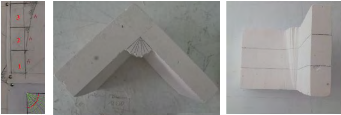
Şekil 21: Divriği Şifhanesi altı kenarlı tonozunun ilk üç parçadan oluşan sıralarının atölyedeki işlem kolaylığı için tek bir blokta gerçekleştirilen kesim işlemi ve montajı (Sevda Atak, 2017).
