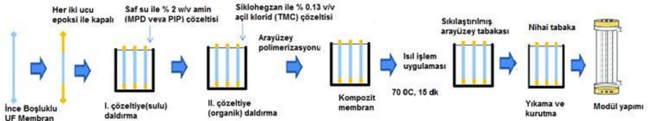
Şekil 1. İFK membranların üretiminde kullanılan arayüzey polimerizasyonu metodu akım şeması.
