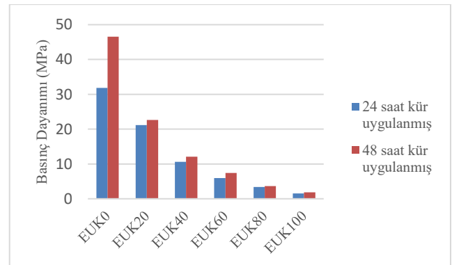
Şekil 4. 24 ve 48 saat 75 °C sıcaklık kürü uygulanan geopolimer harçların basınç dayanımı
