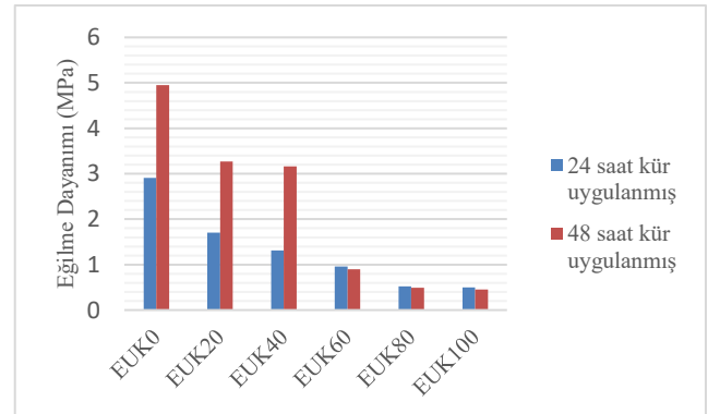
Şekil 3. 24 ve 48 saat 75 °C sıcaklık kürü uygulanan geopolimer harçların eğilme dayanımı
