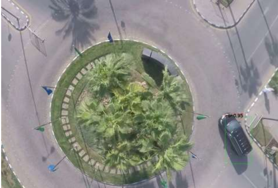
Şekil 4.4- 75m yükseklikten çekilmiş drone görüntüsü üzerinden Faster R-CNN Beslemeli YOLO algoritmasının araç tespit başarısı
