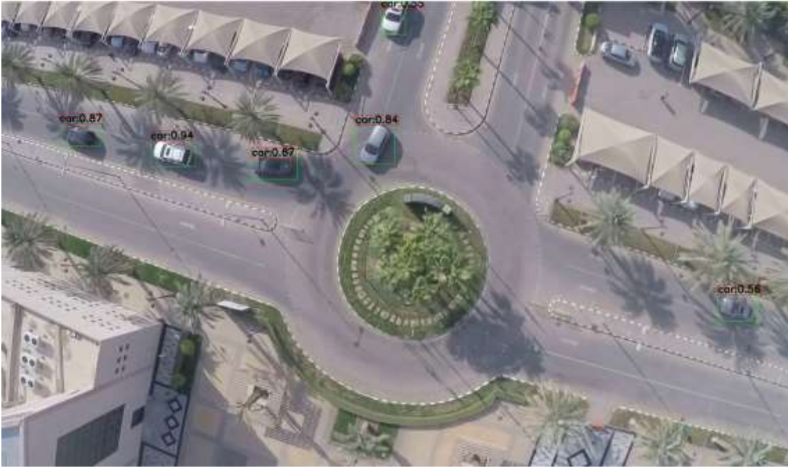
Şekil 4.5 -100m yükseklikten çekilmiş drone görüntüsü üzerinden Faster R-CNN Beslemeli YOLO algoritmasının araç tespit başarısı
