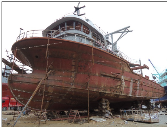
Şekil 2. Çamburnu tersane alanında inşa edilmekte olan bir Karadeniz tipi balıkçı gemisi (Fotoğraf yılı: 2013. Dursun Saral)
