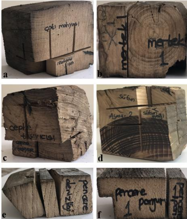
Şekil 1. Eski odun örneklerinin makroskopik görünüşleri (a: çatı mahyası, b: mertek, c: cephe taşıyıcısı, d: sütun ayağı, e: pencere denizliği, f: pencere panjuru).
