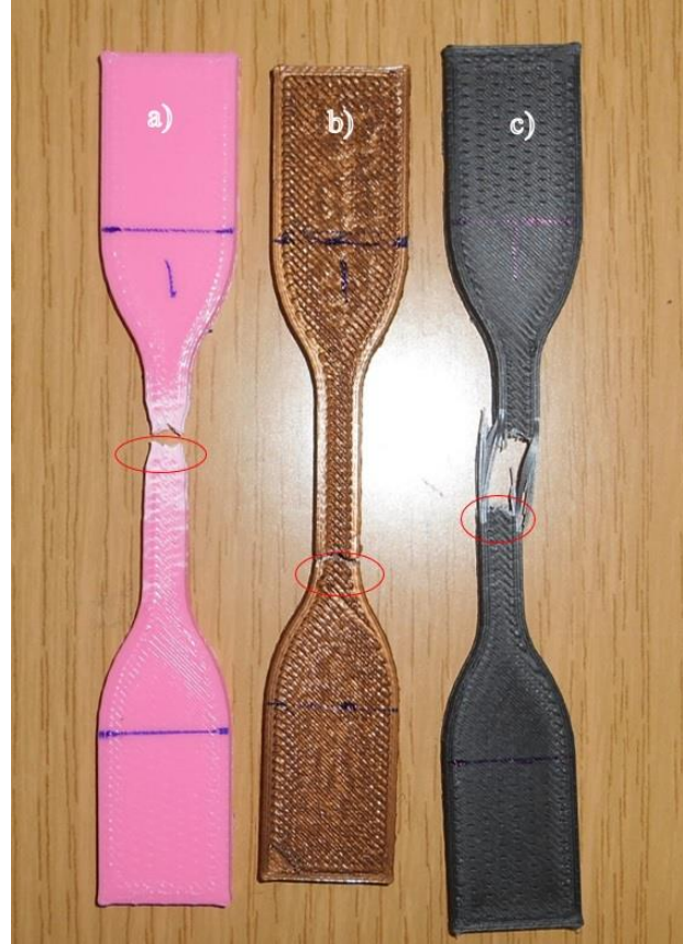
Şekil 8. Çekme testi sonrası numune örnekleri a) PLA, b) bakır takviyeli PLA, c) karbon fiber takviyeli PLA
