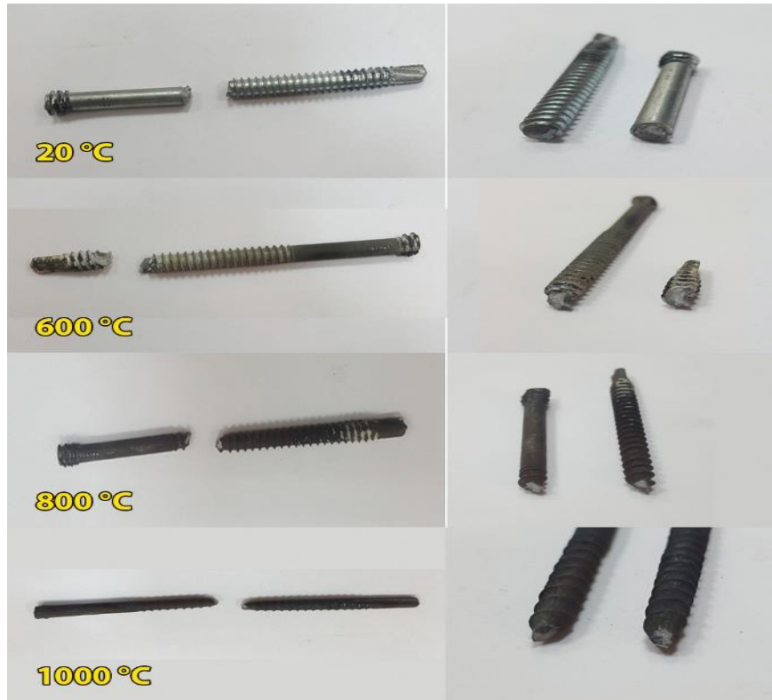
Şekil 7. Isıl işlem sonrası 5.5/6.3*90 vidalarının göçme modları
