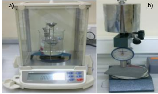
Şekil 3. a) Yoğunluk testi cihazı (And/gr 200), b) Sertlik ölçme test cihazı (Tronic shore A-D)
