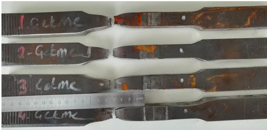
Şekil 9. Çekme testi sonrası kaynaklı birleştirme numunelerinin görüntüleri
