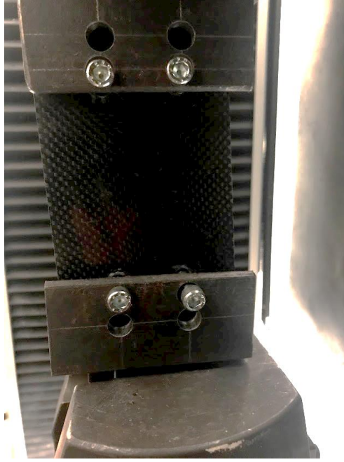
Şekil 4. Universal test cihazına bağlanmış iki cıvatalı test numunesi
