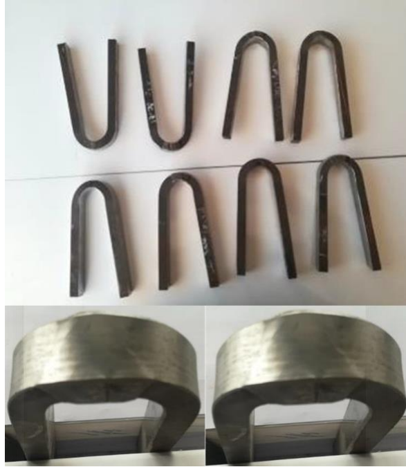
Şekil 10. Eğme testi sonrası numunelerin örnek görüntüleri
