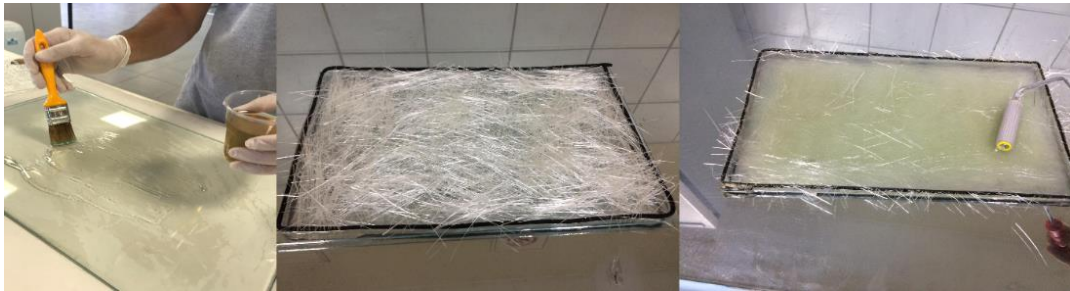
Şekil 3. Hibrit matrisli cam lifli kompozit üretimi
