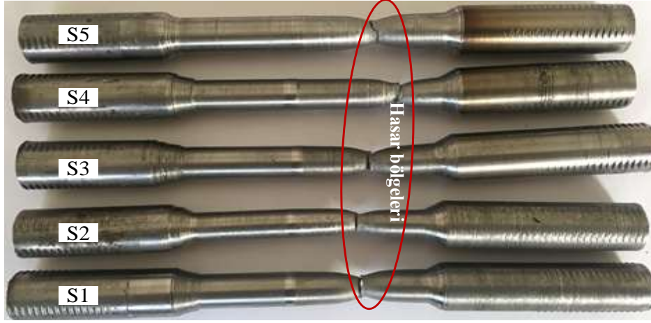
Şekil 11. Çekme testleri sonrası numunelerin kırılma yüzeyleri
