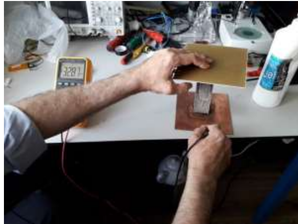
Şekil 1. Elektriksel özdirenç ölçümü
