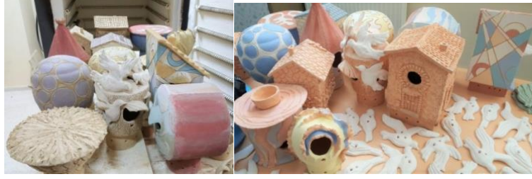
Görsel 17. İlk Pişirim için fırına yerleşmiş (950 °C pişirim) ve pişirim sonrası seramik ürünler (kişisel arşiv)
