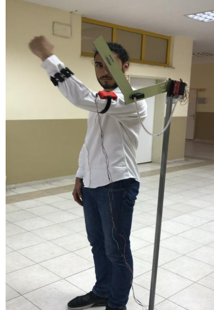
Şekil 12. Üst ekstremitte bir dış iskelet robotun kontrolü için MIMU sensörler vasıtası ile etkileşim ağı tasarımına ait final çalışmaya fotoğrafı
