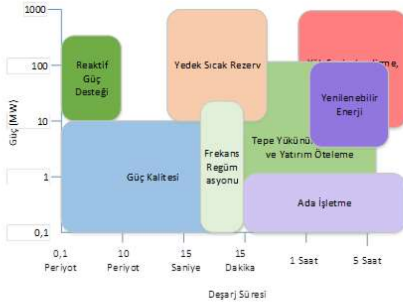
Şekil 8 - Enerji Depolama Sistemi Şebeke Uygulamaları için Güç ve Deşarj Süresi Gereksinimleri
