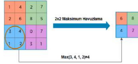
Şekil 1. Maksimum Havuzlama Örneği
