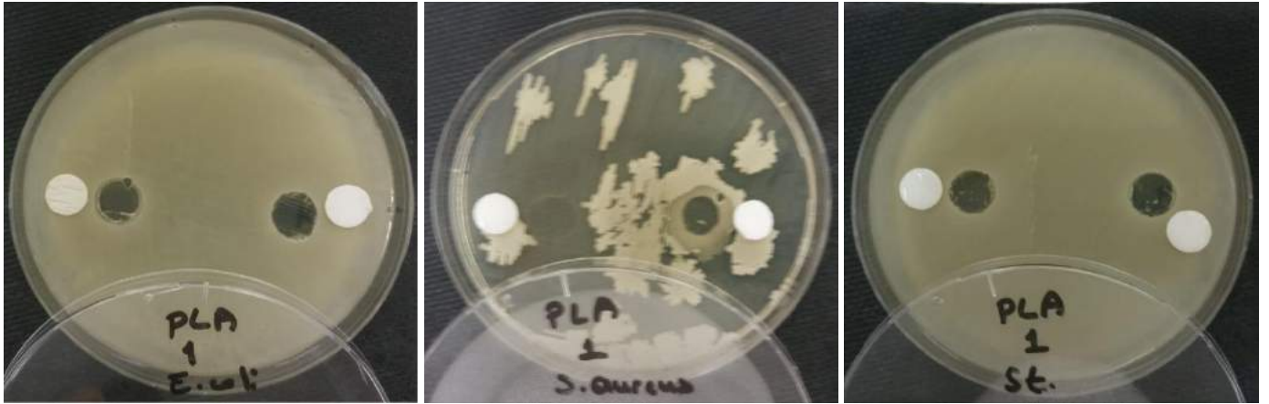
Şekil 20. PLA 1mm telefon korumanın antimikrobiyal özellikleri.
