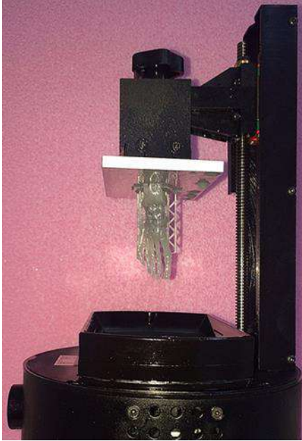
Şekil 7. 3B yazıcının üretim tablasından henüz sökülmemiş anatomik ayak kemik modeli
