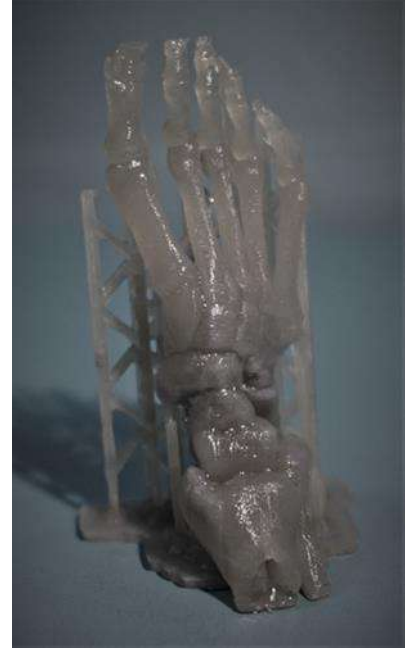
Şekil 8. 3B yazıcıda üretilmiş anatomik ayak kemik modeli
