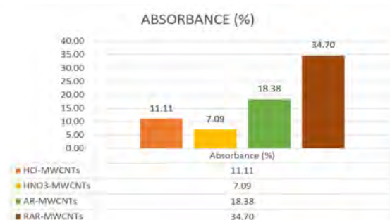
Figure 1. The percentages of adsorption of HCl, HNO 3 , aqua regia (AR) and reverse aqua regia (RAR) on the carbon nanotube.
