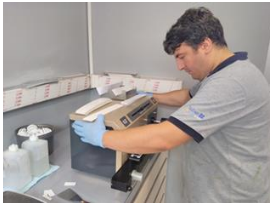
Şekil 2. IGT C1 Test Baskı Makinesi Üzerinde Test Baskılarının Yapılması.
