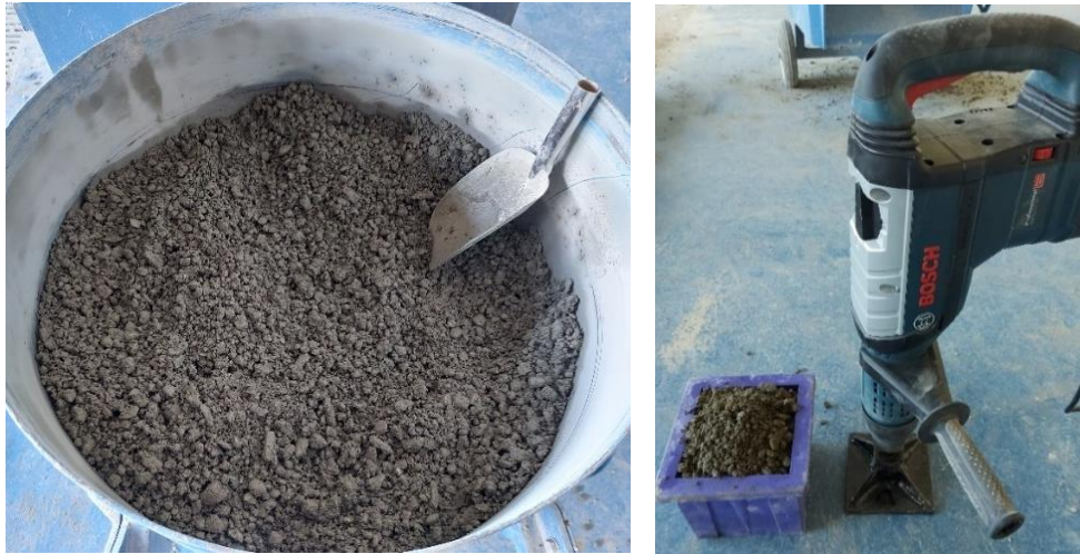
Şekil 2. Mikserde karıştırılmış SSB ve küp örneğin vibratörlü çekiç ile sıkıştırma öncesi görüntüsü
