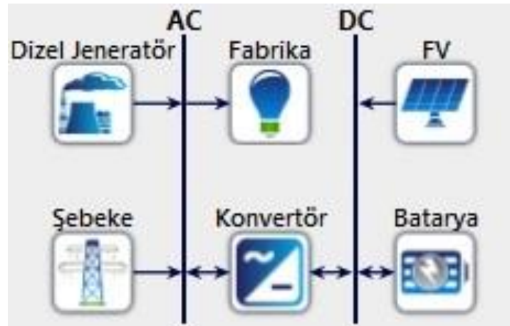
Şekil 1. Hibrit sistemin blok diyagramı
