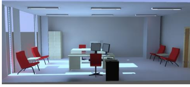
Şekil 8. (a) 300lx yapay aydınlatma ve saat 08.00 gün ışığı (doğrudan ışık) ile test ofisi görünümü;
