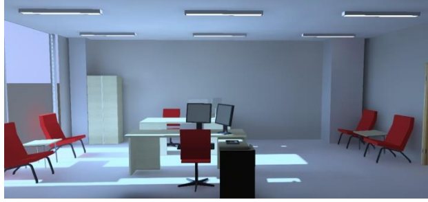
(b) 300lx yapay aydınlatma ve saat 8.00 gün ışığı (doğrudan ışık) ve kontrol kısıtlaması ile test ofisi görünümü.
