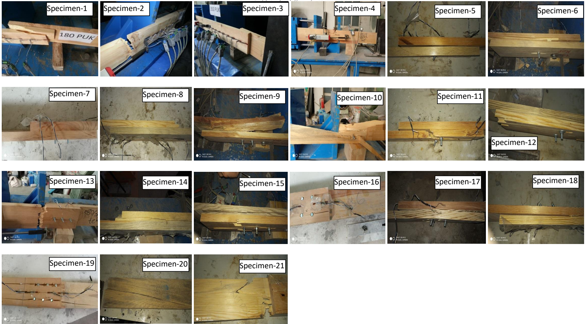
Şekil 5. Deney elemanlarının göçme mekanizmaları
