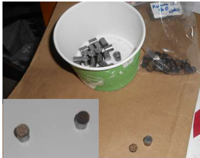
Şekil 3. Hazırlanan çelik pimler ve aşınma numuneleri
