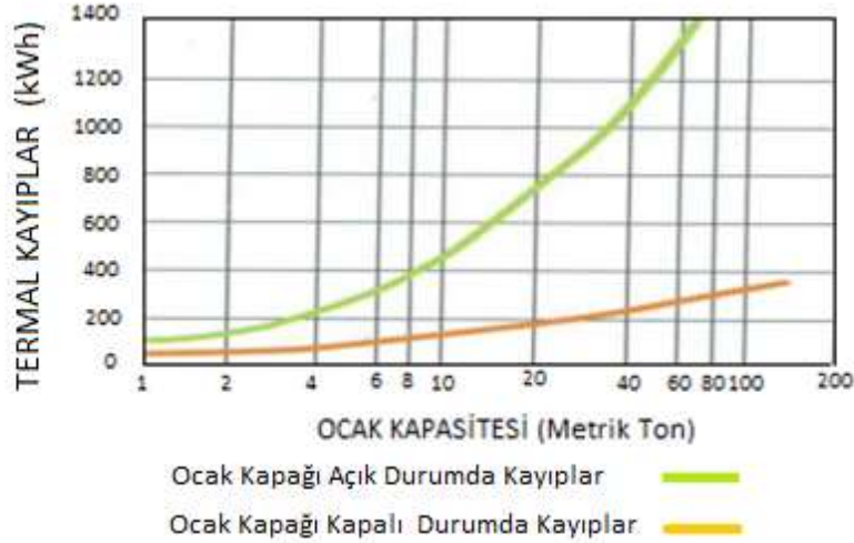
Şekil 5. Ocak kapağı açık ve kapalı olması durumuna göre indiksiyon ocaklarının termal kayıp değerleri (Prabhu, 2008)
