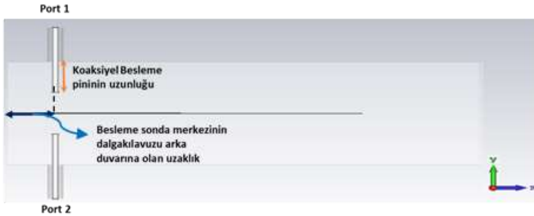
Şekil.4. S-Bant septum kutuplaştırıcının boyuna kesit görüntüsü ve iki portlu eş-eksenli besleme yapısı.
