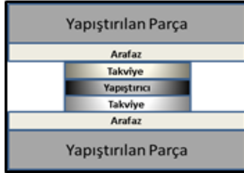
Şekil 1. Tipik bir yapıştırılmalı bağlantı
