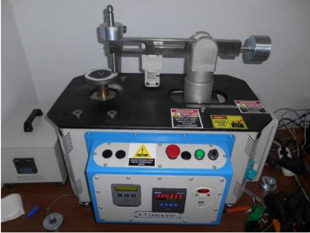
Şekil 4. Aşınma deney düzeneği
