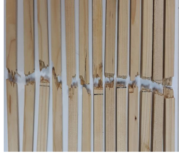
Şekil 1. Dinamik eğilme (şok) direnci testi sonrası örnekler.
