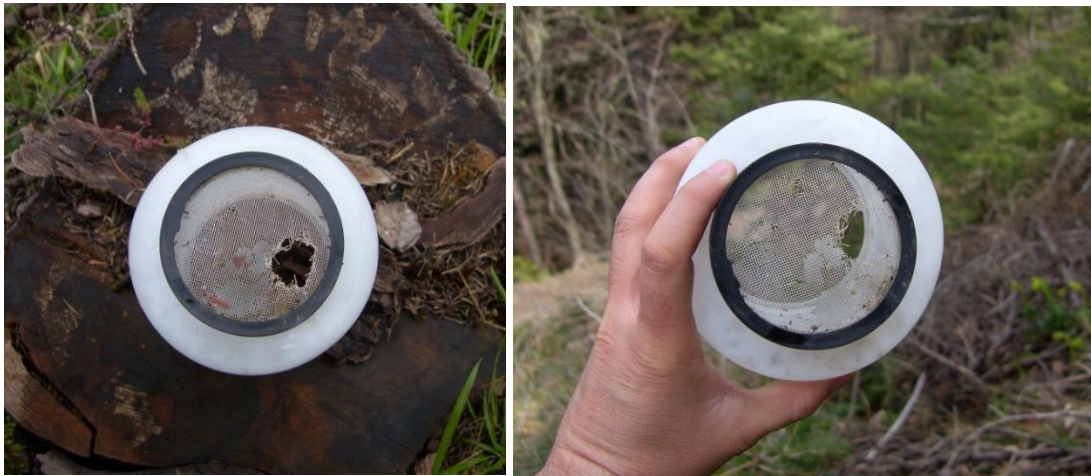
Şekil 1. Toplama kapların alt kısımlarında oluşan delikler (Foto: Y. YILDIZ)
