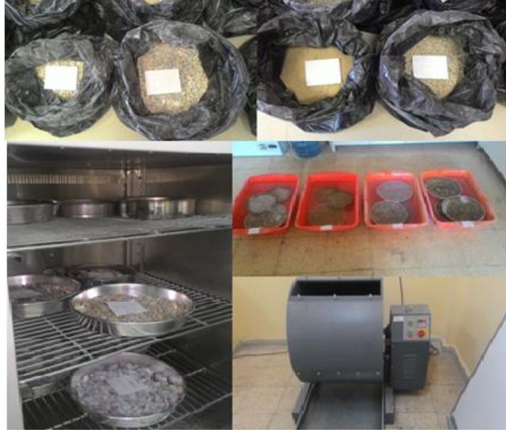
Şekil 3. Agregaların fiziksel özellik deneylerinden görünümü
