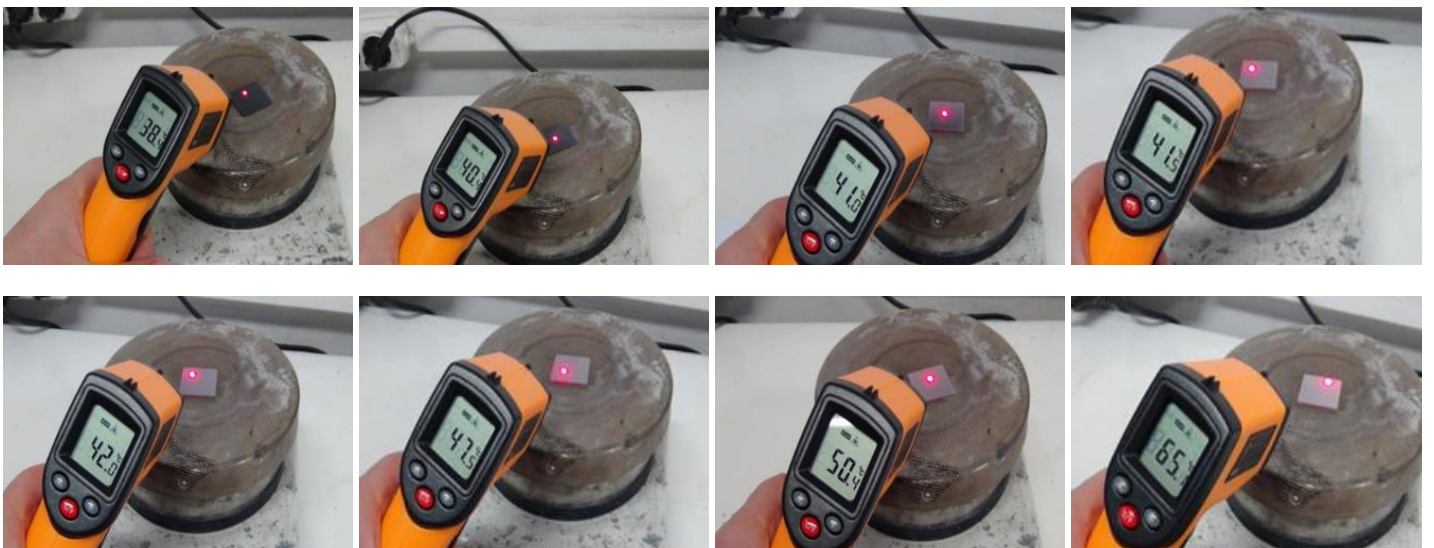
Şekil 9. Siyah renk termokromik kaplamanın artan sıcaklıkla renk değişimi
