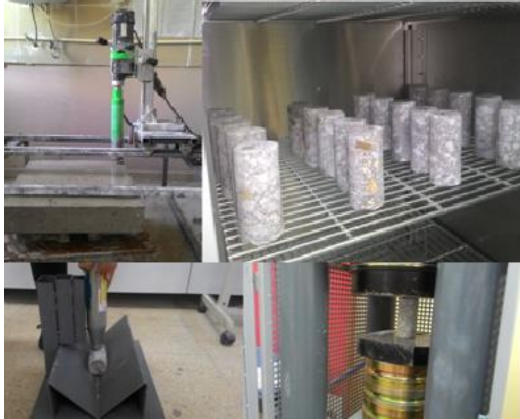
Şekil 5. Beton döküm işlemi sonrası karot alımı ve gerçekleştirilen deneylerin görünümü
