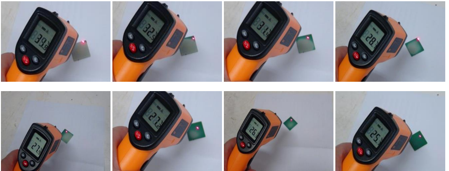
Şekil 8. Yeşil renk termokromik kaplamanın azalan sıcaklıkla renk değişimi
