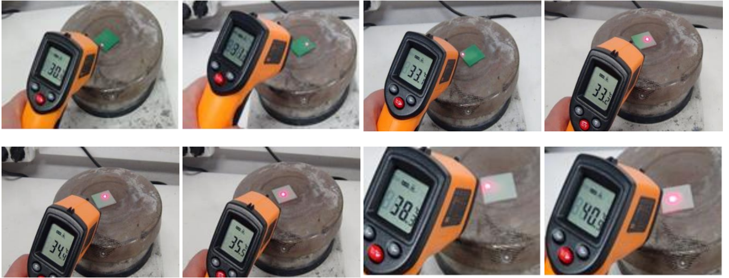
Şekil 7. Yeşil renk termokromik kaplamanın artan sıcaklıkla renk değişimi
