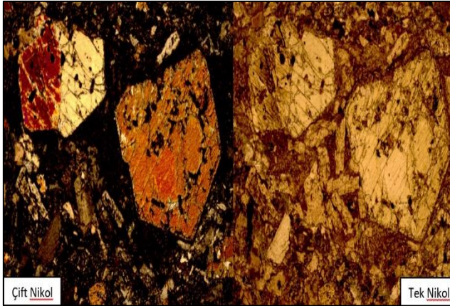
Şekil 3. Tüfitlerin polarizan mikroskop altında çekilen çift ve tek nikol görüntüleri
