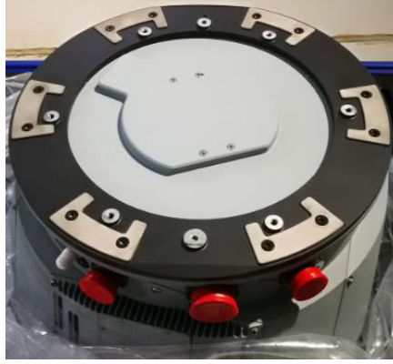
Şekil 2. Elektro-Optik Kamera Mekanik Montaj Arayüzü
