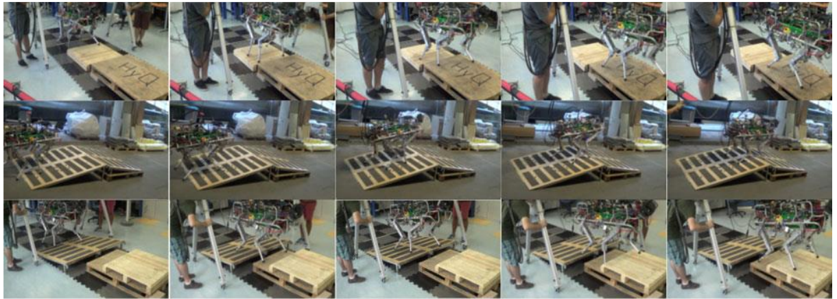
Şekil 18. HyQ robotunun engeli parkurda (rampa, basamak ve boşluk) yürüyüşü Figure 18. HyQ robot walking on a rugged parkur (ramp, step and space)
