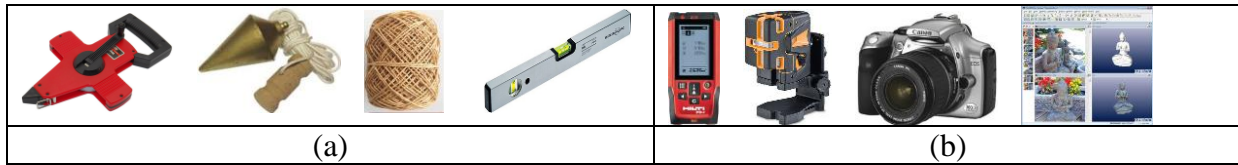
Şekil 1. Rölove almında kullanılan alet ve cihazlar (a) klasik cihazlar; çelik metre, şakül, ip ve su terazisi (b) teknolojik cihazlar; lazer metre, lazer şakül, SLR fotoğraf makinesi ve fotomodeler yazılımı.
