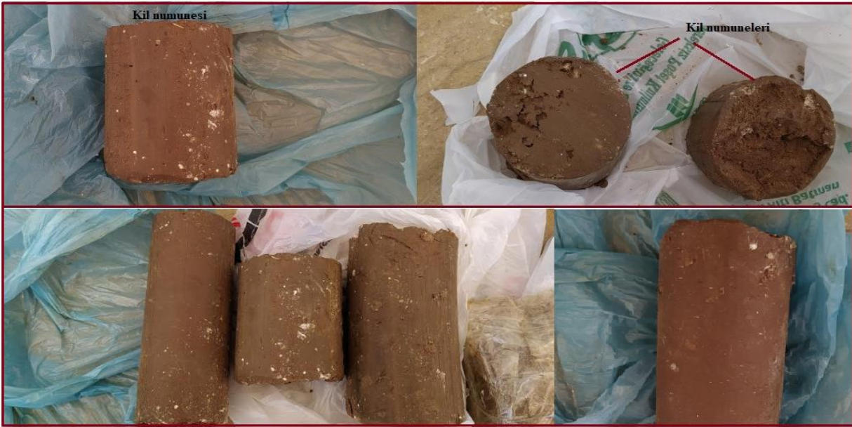
Şekil 11. Killi seviye birimlerinden alınan örselenmemiş numunelerin bir bölümünün görünümü Figure 11. View of some of the undisturbed samples taken from clayey level units
