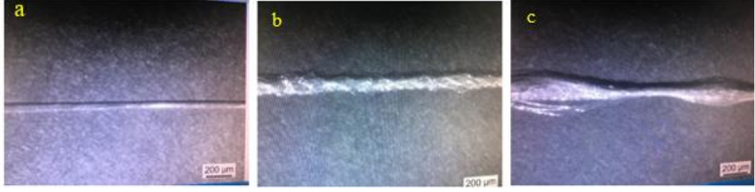
Şekil 2. İpliklerin mikroskop görüntüleri (2,5x) a. 167/48 FDY, b. 167/48 tekstüre, c. puntalı iplik Figure 2. Microscope images of yarns (2.5x) a.167/48 FDY, b. 167/48 texturized, c. intermingled yarns
