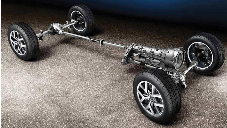
Şekil 1. Pick-up sınıfı araçlar için aktarma organlarının yerleşimi
