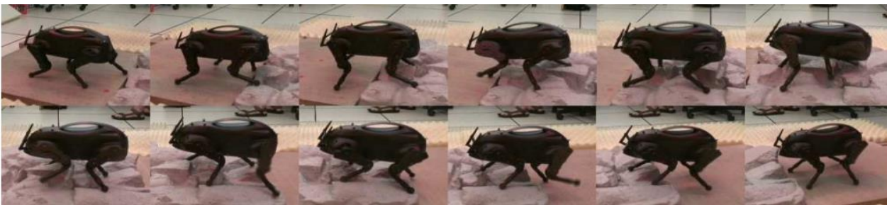
Şekil 13. LittleDog robotunun engebeli zeminde yürüyüşü Figure 13. LittleDog robot walking on rough/uneven ground
