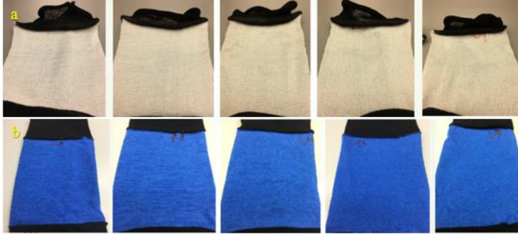
Şekil 1. KNUM1, KNUM2, KNUM3, KNUM4 ve KNUM5 iplikler kullanılarak örülen çorap görüntüleri: a. boyasız, b. boyalı
