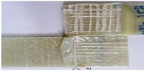
a) l_b=25 mm / [45^\circ/-45^\circ/0^\circ/90^\circ]_s /15 gün /40 °C/FH+YH
