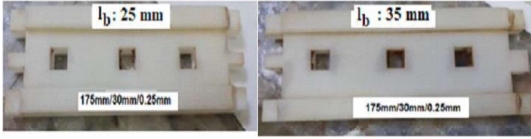
Şekil 2. l_b = 25 \text{ mm} ve l_b = 35 \text{ mm} için üretilen kalıplar Figure 2. Molds produced for l_b = 25 \text{ mm} and l_b = 35 \text{ mm}
