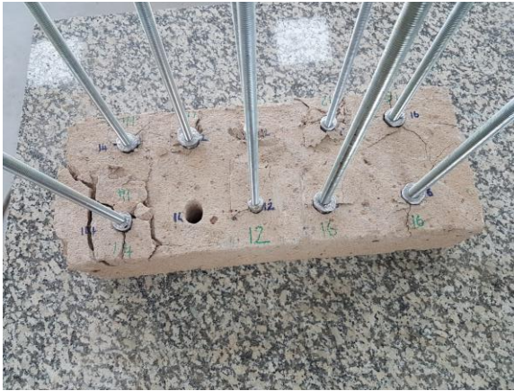
Şekil 4. Deney sonucunda taş bloklarda meydana gelen deformasyonlar
