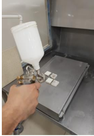
Şekil 5. Spreyleme tekniği ile sır uygulama işleminin gösterimi (Demonstration of the glaze application process with the spraying technique)
